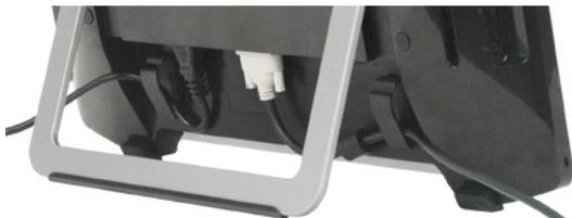
Después de acoplar todos los cables necesarios al monitor y al equipo (consulte la sección [Conectar el monitor](#)), utilice la brida para organizar los cables tal y como se muestra arriba.
